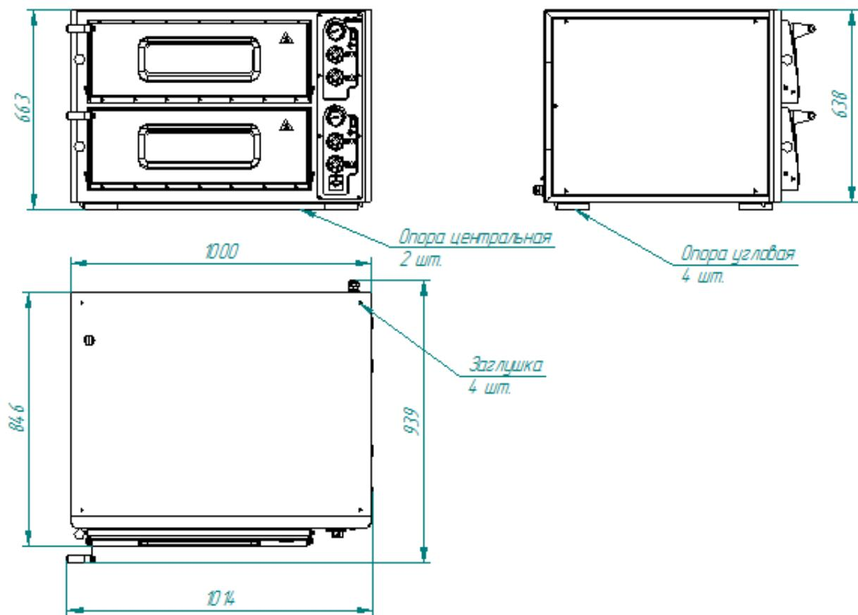
Рис.2 Общий вид печи ПЭП-4х2
